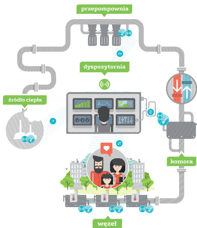
Rys. 13. Schemat działania inteligentnej sieci ciepłowniczej
